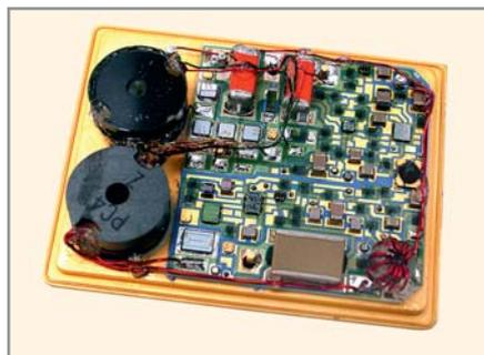
Рис. 1. Конструкция гибридно-плёночного DC/DC-преобразователя серии SMHF (крышка снята)
